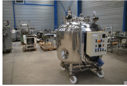
1 CUVE/TANK SCHUBERT en inox double enveloppe - 1200 litres (ref: 1299)
