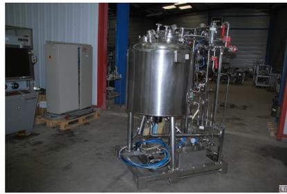
**1 SKID avec CUVE/TANK RHEO MIX** double enveloppe avec agitateur fond de cuve: 350 litres (ref: 1110)
