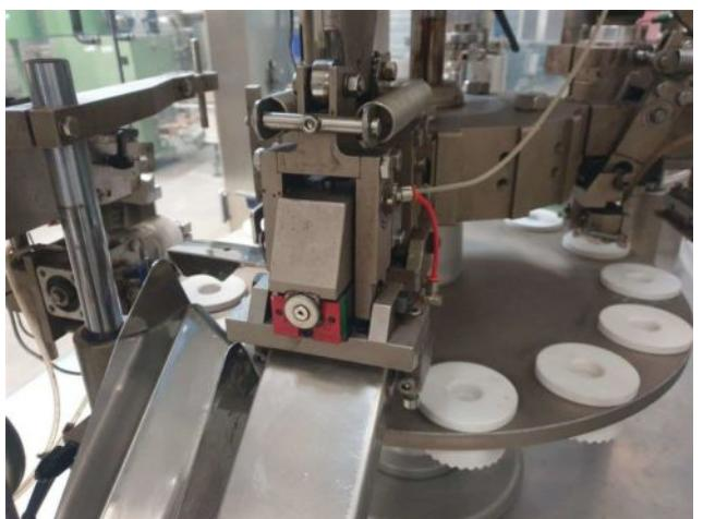
DOSEUSE FERMEUSE TUBE EN PLASTIQUE ET METALO-PLASTIQUE
