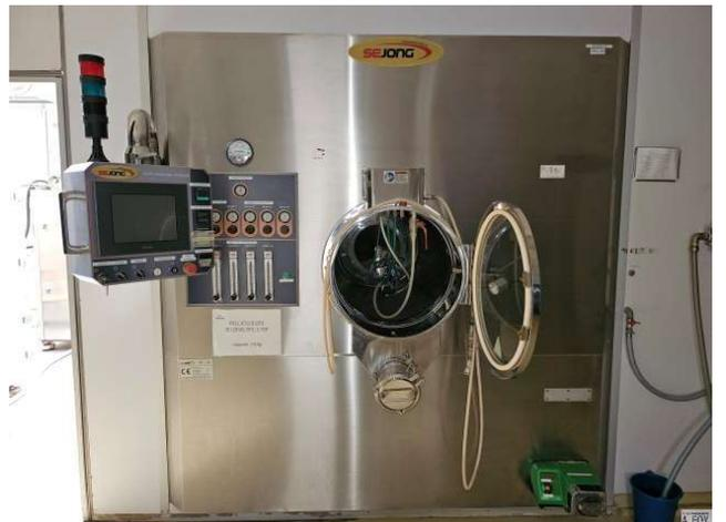
**TURBINE A PELLICULER EN INOX. CAPACITE DE 210 A 410 KG**
